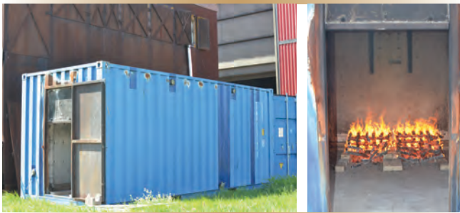
Figure 3. Vue externe de l'unité d'essai de cloison et du compartiment de simulation d'incendie.
