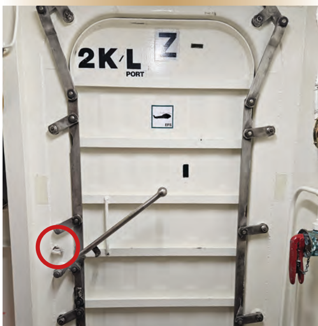
Figure 1. Porte étanche à action rapide à bord d'une frégate de classe Halifax .
