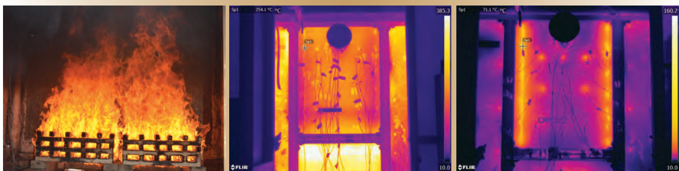
Figure 5a. Échéancier d'intervention rapide : 3 à 5 minutes après l'allumage (alarme : 1 à 2 minutes).
