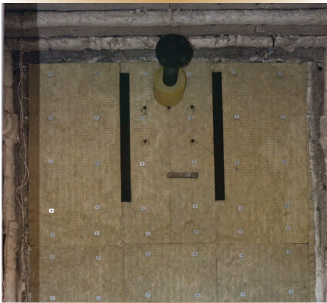
Figure 2. Isolant en laine de roche A-15 installé sur la cloison d'essai, montrant des lisses exposées, des tourniquets de fermeture et une poignée simulés exposés au feu.
