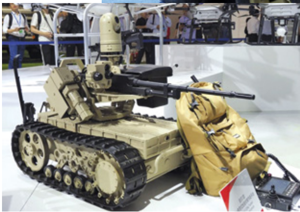
Le Sharp Claw I est un petit robot éclairteur à chenilles conçu pour être transporté dans la soute du Sharp Claw II.
