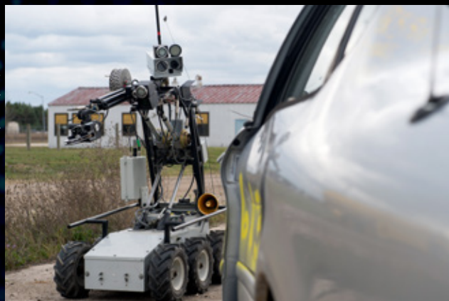
Un véhicule-robot de téléreconnaissance inspecte un véhicule contenant un dispositif explosif improvisé simulé soupçonné durant l'exercice ARDENT DEFENDER.
