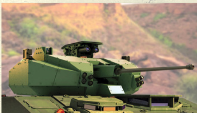
Le poste de tir télécommandé SAMSON tout-en-un fournit aux véhicules de combat une protection comparable à celle d'un char de combat principal ainsi qu'une puissance de feu adaptée à la mission, sans pour autant réduire la mobilité.
