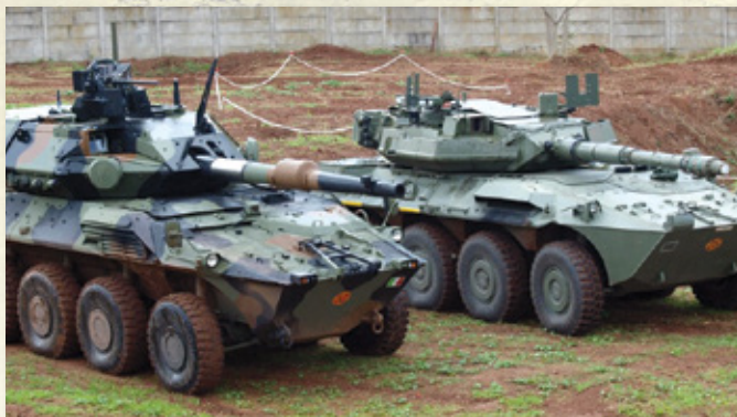
Le Centauro II, à gauche, et son prédécesseur, à droite. Plus grande, offrant une plus grande protection et une puissance de feu plus importante, et pouvant être connectée à l'environnement en réseau : telles sont les principales caractéristiques de la nouvelle plateforme.
