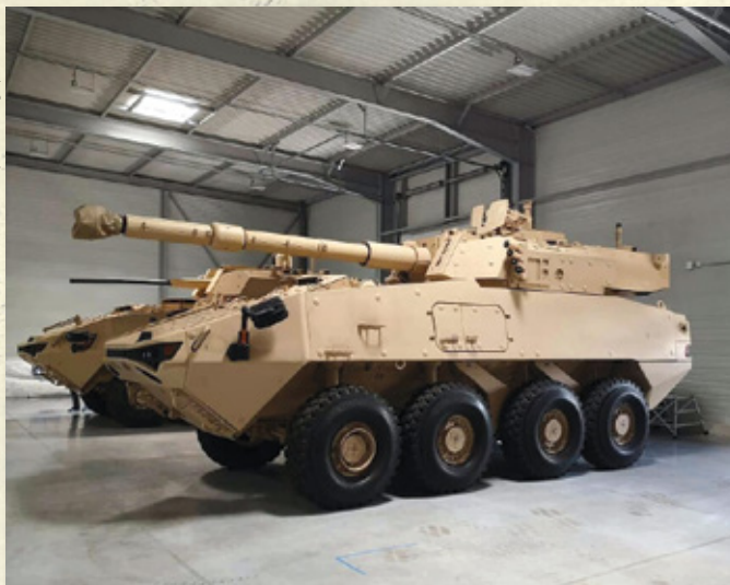
Véhicule blindé léger 700S en version pour appui-feu direct en calibre 105 mm et 30 mm.
