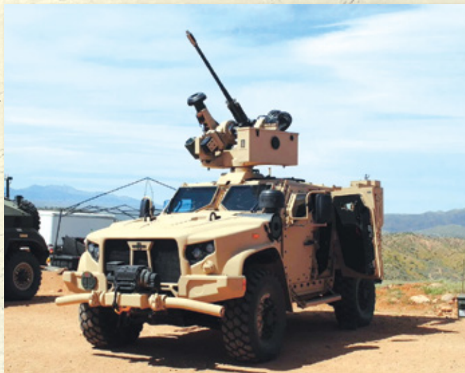
Véhicule tactique léger interarmées équipé du Protector RWS-LW30 et du missile guidé antichar Javelin. Pourrait-il s'agir d'une amélioration potentielle du poste de tir télécommandé pour le véhicule de patrouille tactique blindé?
