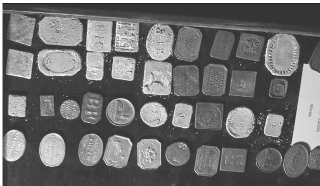
Figure 1. Les jetons en plomb couverts de corrosion blanche et entourés de particules blanches sont atteints de corrosion active. Les autres ne le sont pas.
