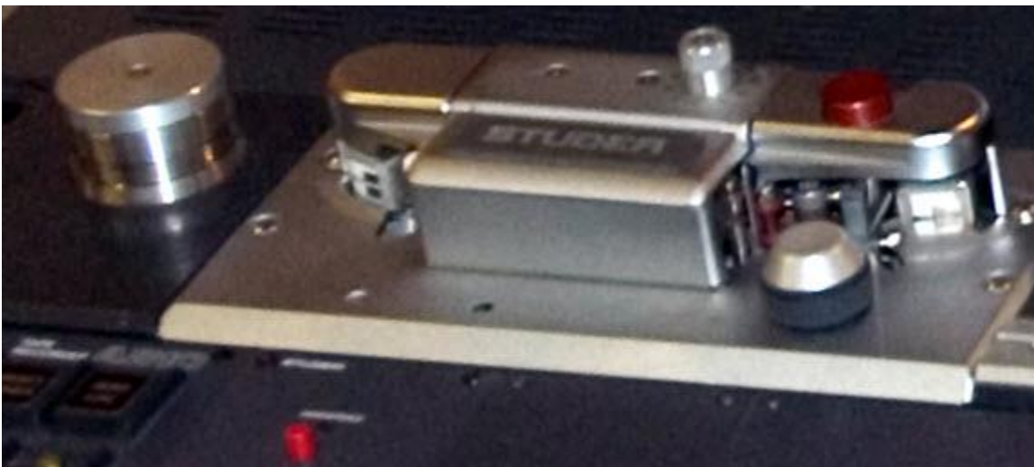
Figure 5. Noter le bouton de réglage externe de l'azimut (le cylindre argent) juste derrière le « R » du logo « STUDER » sur le bloc de tête.
