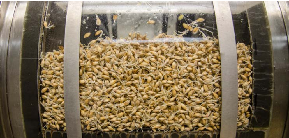
Collection de photos du LRG : Cages contenant des grains d'orge pendant le maltage dans le système de micromaltage Phoenix.
