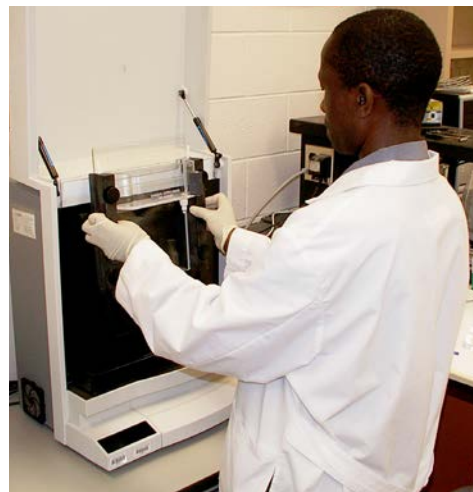
Un technicien pose une cassette de gel dans un analyseur d'ADN automatisé en vue de l'analyse des microsatellites de l'ADN.
