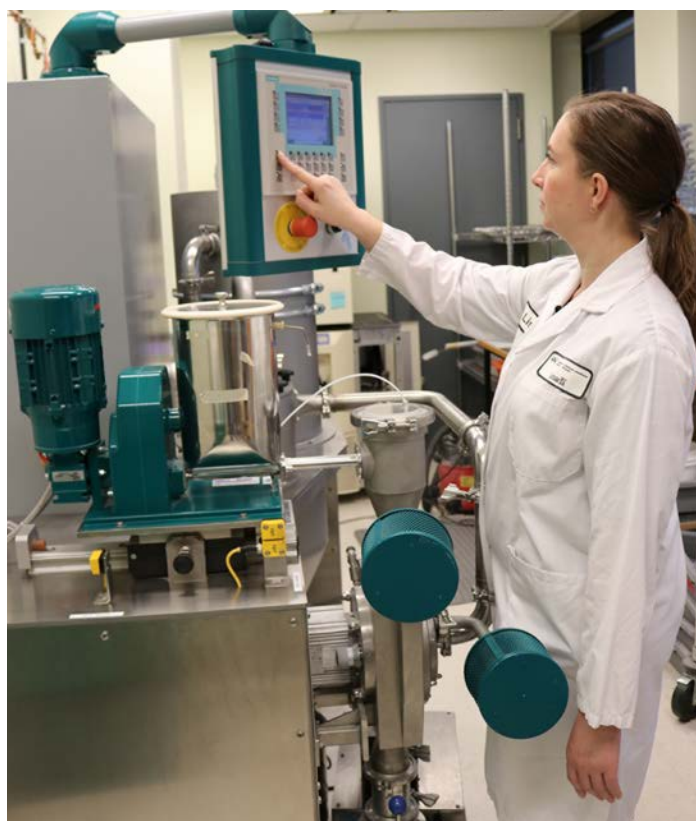
Classificateur pneumatique de laboratoire utilisé pour séparer la farine de pois en une fraction riche en protéines et une fraction riche en amidon
