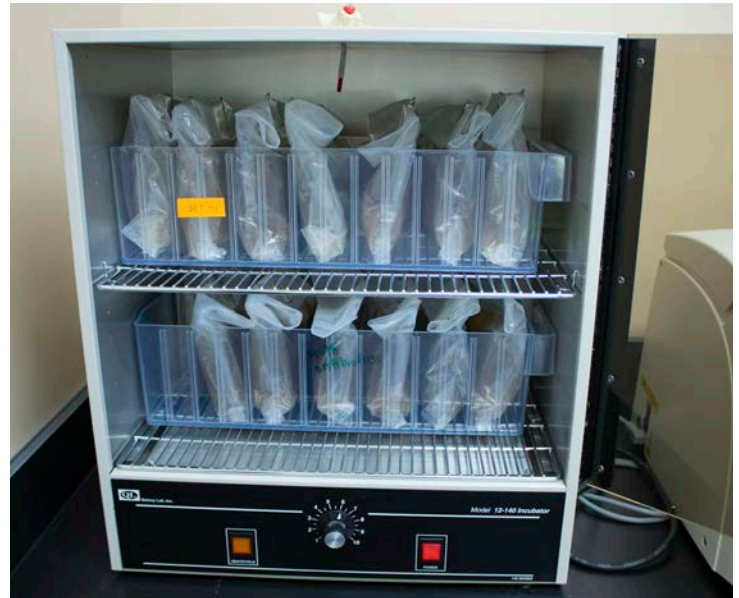
Durant l'enrichissement, il est essentiel de maintenir la température et les conditions propices à la croissance des bactéries en incubateur.
