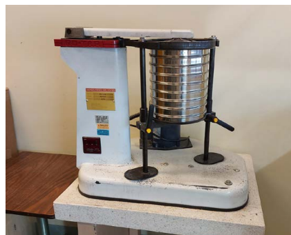
Figure 2 Appareil de mesure de la taille des particules Ro-Tap utilisé pour séparer les particules de différentes tailles d'avoine moulue.
