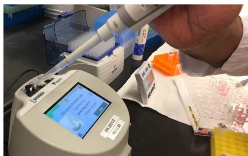
Figure 1 Chargement d'une aliquote d'échantillon dans un lecteur de bandelettes d'analyse à flux latéral aux fins du dosage du DON.
