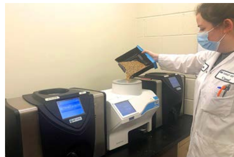
Figure 4 Humidimètres servant à l'essai de contrôle de la teneur en eau : modèles AM 5200-A de PerkinElmer et GAC 2500-INTL de DICKEY-john.
