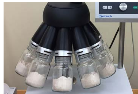
Figure 2 Vue de face d'un diviseur rotatif divisant de manière représentative les échantillons qui serviront à l'essai de contrôle de l'indice de chute.
