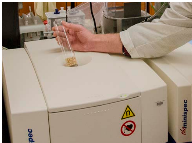
Figure 1 Appareil de résonance magnétique nucléaire (RMN) à impulsion servant à déterminer la teneur en huile brute.
