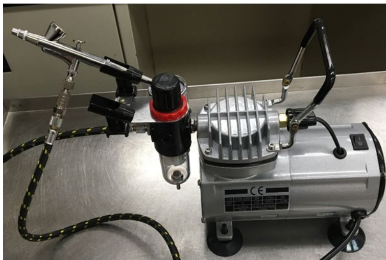
Figure 1 Système de pistolet à air polyvalent utilisé pour appliquer l'huile minérale
