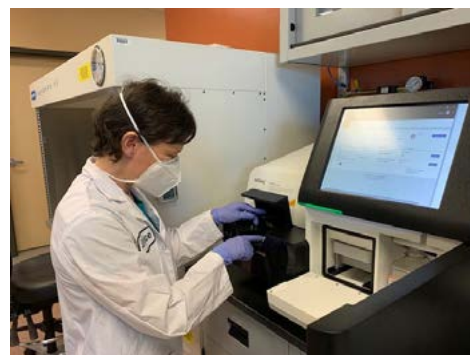
Figure 1 Équipement robotisé de séquençage d'ADN à haut débit utilisé pour recueillir des informations sur le génome entier de micro-organismes et de grains cultivés.
