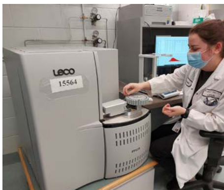
Figure 3 Équipement utilisé pour le dosage de l'azote par combustion (CNA).
