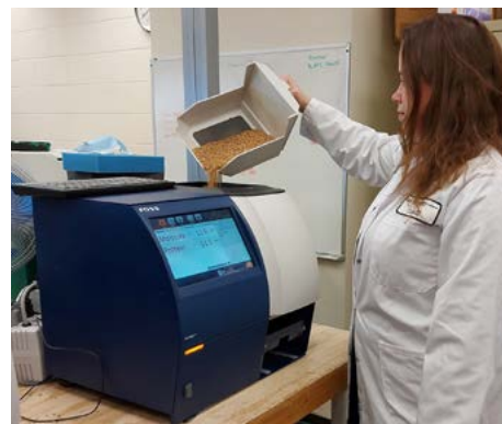
Figure 4 Instruments de transmission dans le proche infrarouge (NIT) utilisés pour prédire la teneur en protéines.
