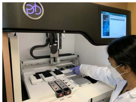
Figure 1 Équipement robotisé de séquençage d'ADN à haut débit utilisé pour recueillir des informations sur le génome entier de micro-organismes et de grains cultivés.
