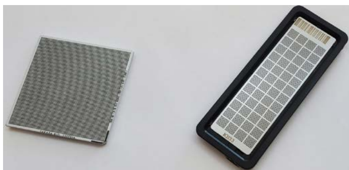
Figure 3 Pucés à ADN permettant d'effectuer des milliers de tests ciblés pour le génotypage de l'ADN en une seule fois. Les photos ci-dessus montrent une plaque Takara SmartChip (à gauche) et une plaque OpenArray™ (à droite).
