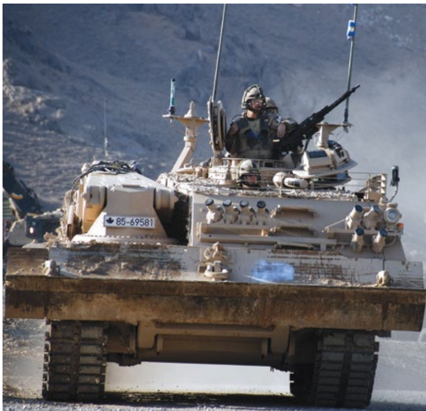
Dans les limites d'un centre de résistance près de Panjwayi, un véhicule de dépannage blindé lourd se prépare à partir dans le cadre d'un convoi. Ce type de véhicule est conçu pour dépanner les nouveaux chars Leopard 2.
