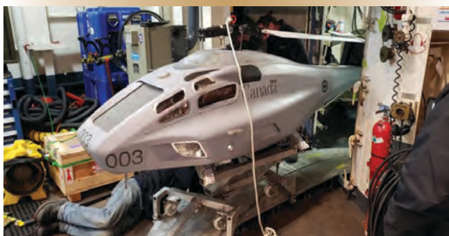
Figure 5. Le V-200 à bord d'une frégate. Le système de chenilles sur mesure a été conçu par QinetiQ Target Systems pour traverser l'aéronef à partir de la soute à torpilles jusqu'au hangar.
