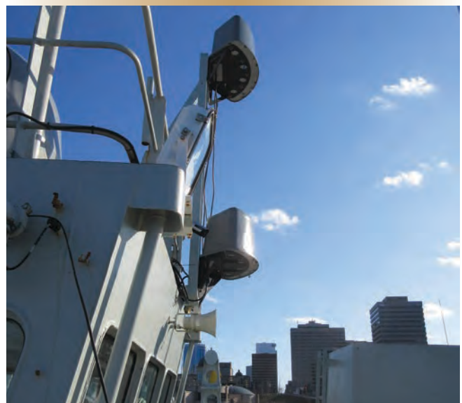
Figure 4. La configuration de l'antenne de la superstructure du NDC pour le SATP Puma a fait l'objet de plusieurs itérations de développement, de conception et d'intégration pour obtenir le meilleur ajustement possible.
