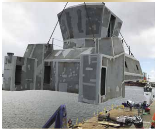
Figure 4. La superstructure assemblée à l'installation des Industries Océan à Québec est transportée à l'extérieur du hangar de construction en vue de son transport sur l'eau sur 120 km le long du fleuve Saint-Laurent jusqu'au chantier naval de L'Isle-aux-Coudres.
