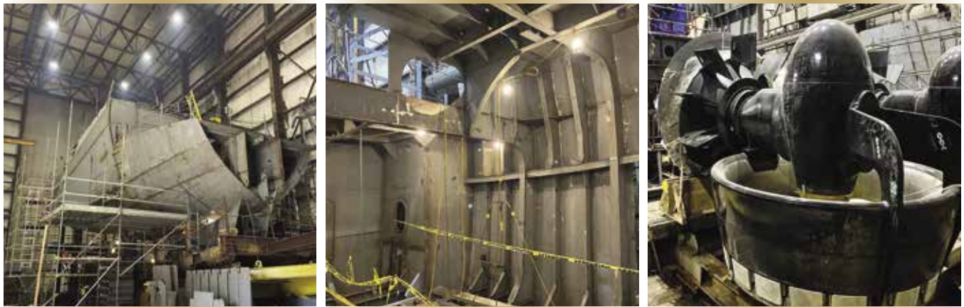
Figure 5. Le premier gros remorqueur naval (Hull 228) prend forme à gauche, avec une vue intérieure de la salle des machines au centre, et un dispositif de propulsion orientable en azimuth qui attend d'être installé à droite.
