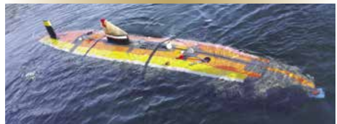
Figure 4. Solution mobile autonome de mesure des signatures magnétiques sous l'eau.
