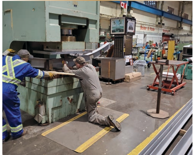
Figure 4. Quatorze membrures et lisses ont dû être mesurées et remises à neuf par l'atelier d'usinage avant d'être installées et soudées à bord.
