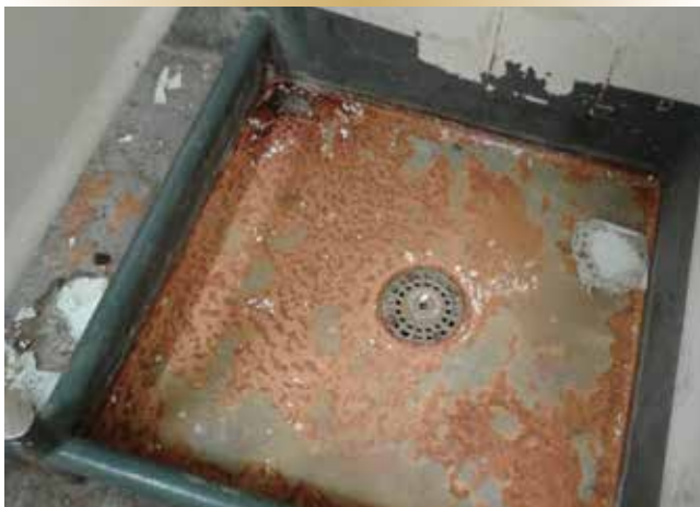
Figure 10. Corrosion cachée du drain de lavabos d'équipage où la crépine en bronze touche au pont en acier doux sous les tuiles.
