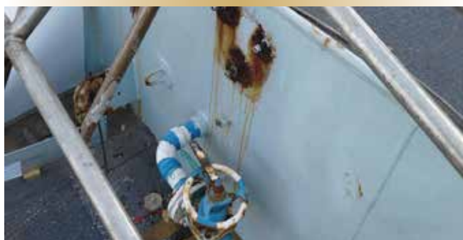
Figure 5. Raccords de métaux dissemblables dans le pont exposé d'une frégate.
