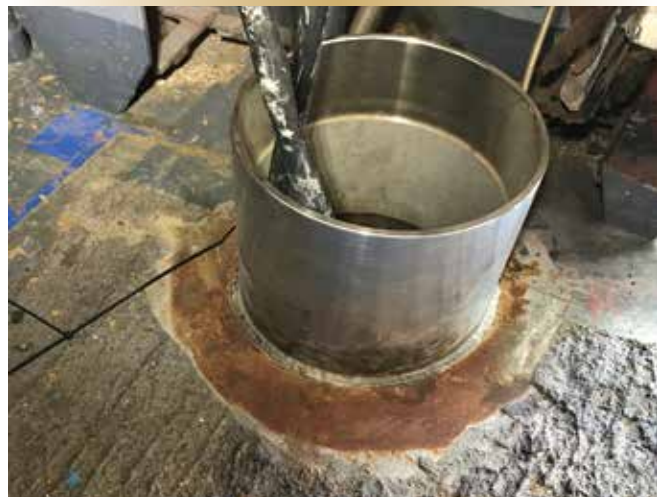
Figure 4. Manchon en acier inoxydable sans revêtement qui est soudé au pont en acier doux d'une frégate de la classe Halifax.
