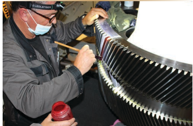
Figure 3. On applique du rouge à marquer de Dykem sur l'échantillon de dent pour vérifier la justesse de l'engrènement dans des conditions de charge opérationnelle en mer.
