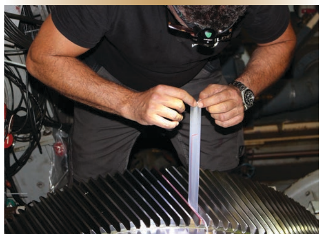
Figure 5. La portée de l'engrènement est transférée du pignon d'engrenage bâbord sur un ruban adhésif, que l'on appose ensuite sur une feuille de papier pour la conserver dans les dossiers.
