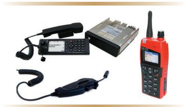
Unité portable SLRCI PUMA (à droite), station fixe et un adaptateur de masque ARA pour le contrôle des avaries.
