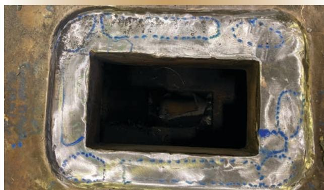
Figure 4b. Chemin de clef – défauts décelés par contrôle aux ultrasons (6 mai 2022).
