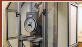
Instrument d'essai Charpy de la section des matériaux de pointe
