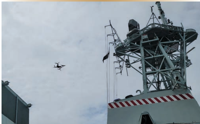
Figure 4. Les dangers autour de la structure d'un navire sont nombreux, ce qui fait de la capacité d'évitement d'objets autonomes du drone Skydio X2D une caractéristique clé du système.
