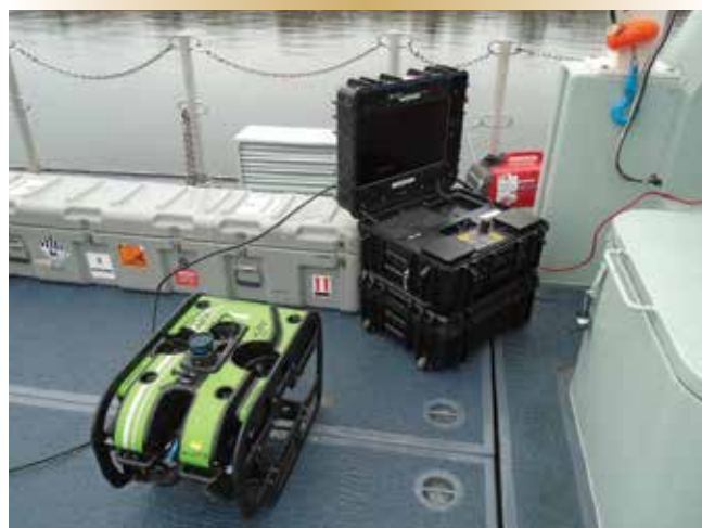
Des outils tels que le VTG SeaBotix de Teledyne (ci-dessus) et le VTG DTG2 de Deep Trekker Inc. (ci-dessous) permettent aux techniciens d'examiner facilement l'état de la coque sous-marine d'un navire.
