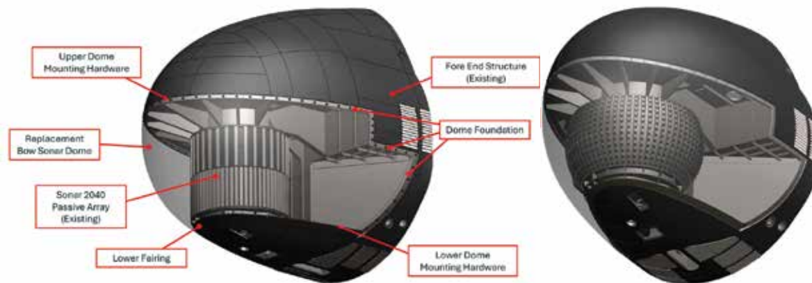
Comparaison de l'array 2040 existant (à gauche) avec le nouveau réseau de la proue de la classe Victoria (à droite).
