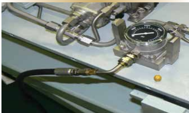
Figure 6. Manomètre à surveiller
