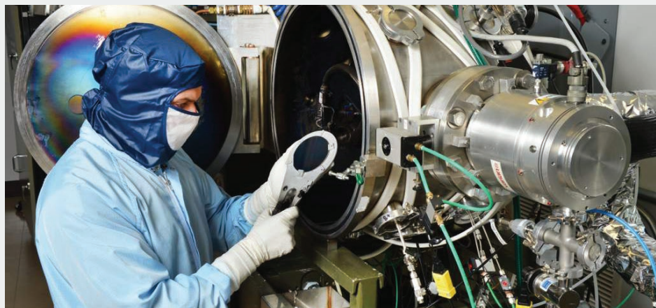
Les appareils de photonique augmentent les capacités visuelles lors d'opérations de surveillance et de reconnaissance. La photo ci-dessus montre un instrument de dépôt de couches minces.
