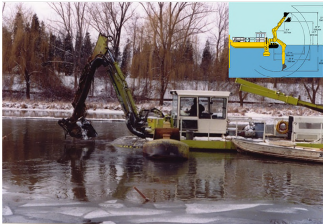
Figure 3-8 : Drague hybride Amphibex (reproduction autorisée par ECCC).
