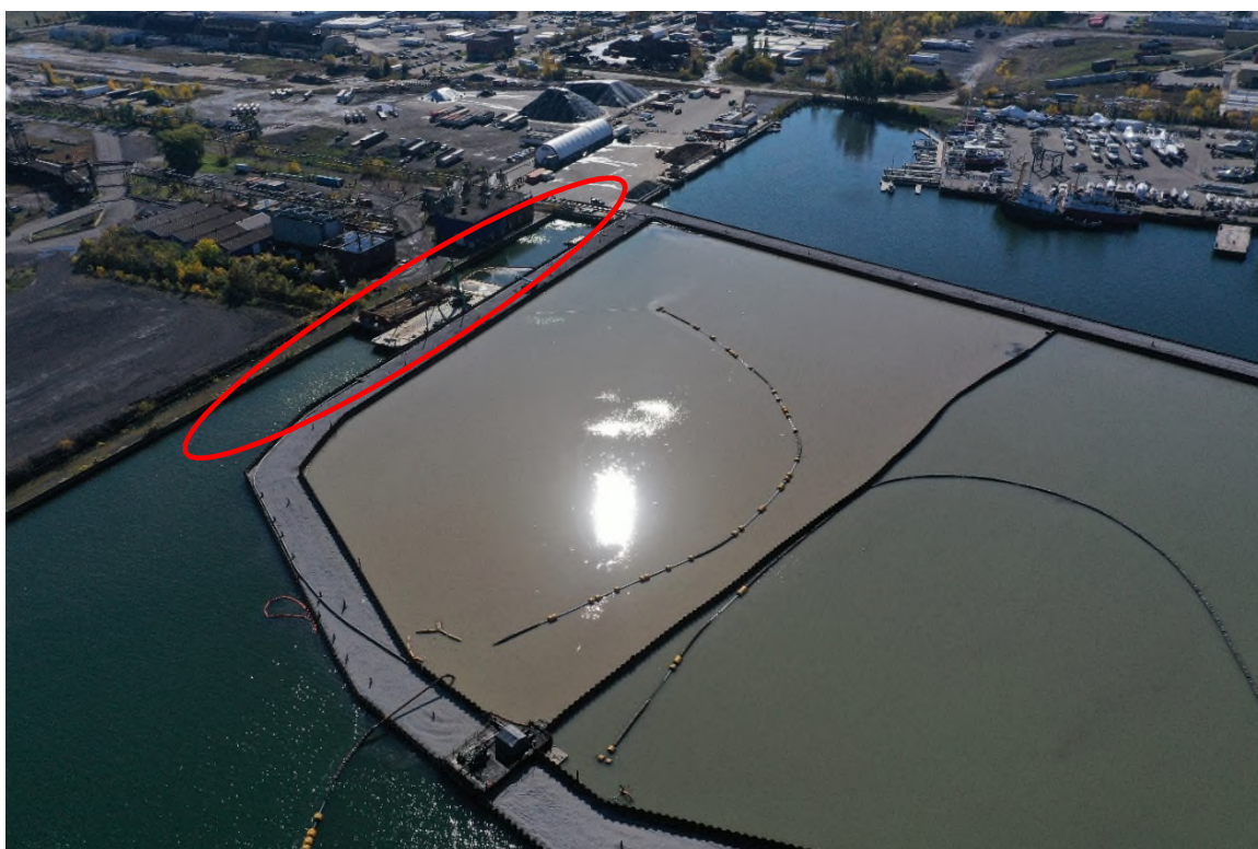
Figure EC4-6 : Le recouvrement d'isolement de la Stelco situé dans le canal (indiqué en rouge) entre la Stelco et l'ICA (reproduction autorisée par Riggs Engineering).
