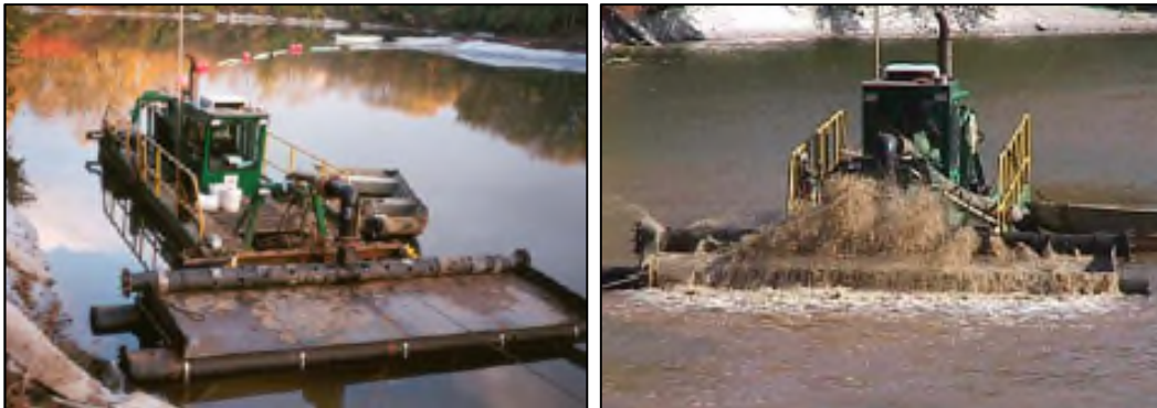
Figure 5-12 : Barge à fond plat pour l'épandage utilisée à Mock's Pond (Indiana) [reproduction autorisée par M. Palermo et C. Vogt].
