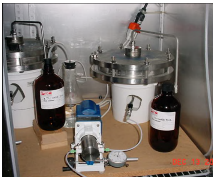
Figure 4-5 : Essai de lixiviation en colonne en couche mince (Blasland, Bouck & Lee inc. et coll., 2006; Brannon et coll., 1994).
