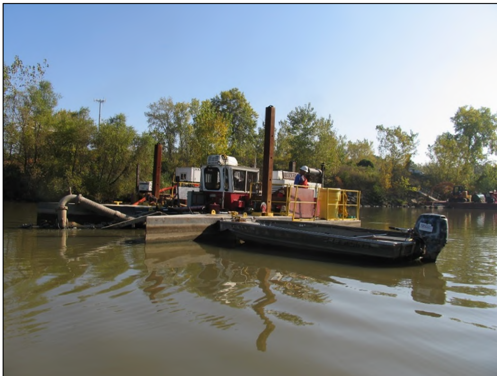
Figure 3-7 : Drague hydraulique (reproduction autorisée par ECCC).
