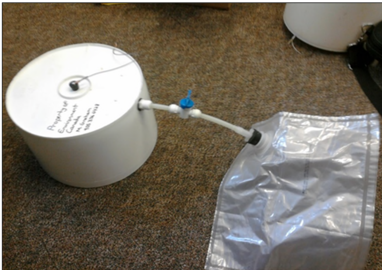
Figure 5-4 : Un compteur des eaux d'infiltration d'Environnement et Changement climatique Canada (reproduction autorisée par ECCC).
