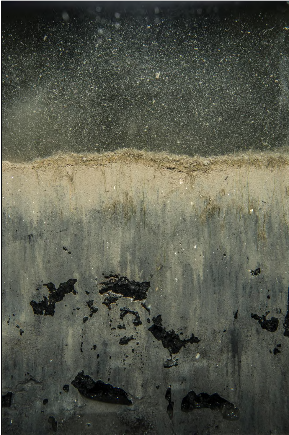
Figure 5-3 : Image du profil des sédiments montrant l'eau, l'interface eau-sédiment et les sédiments (reproduction autorisée par Pêches et Océans Canada).
