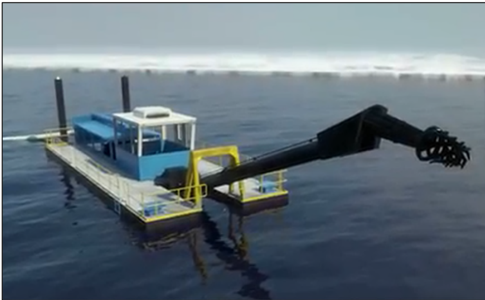
Figure 3-6 : Drague hydraulique (reproduction autorisée par Pacific Productions).
