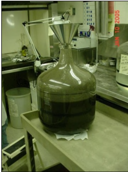
Figure 4-6 : Essai d'adsorption par les milieux par lot séquentiel (Blasland, Bouck & Lee inc. et coll., 2006).
