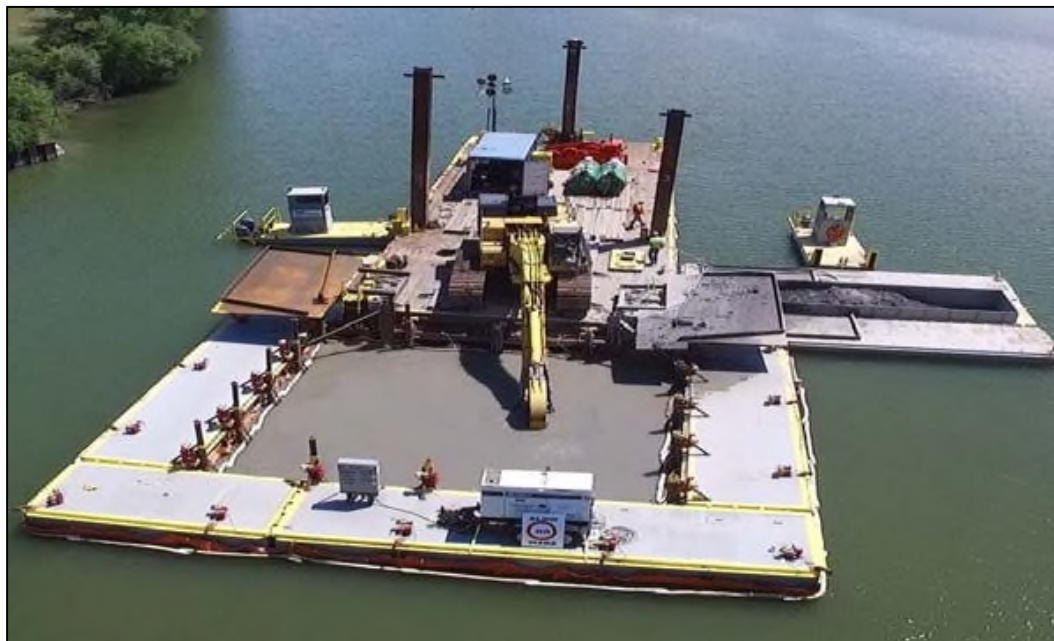
Figure 3-16 : Barge-grue avec puits central rattaché et bacs récepteurs en usage (M. Roberts, A. Corbin, P. Doody, T. Peters et C. Robinson, 2017).
