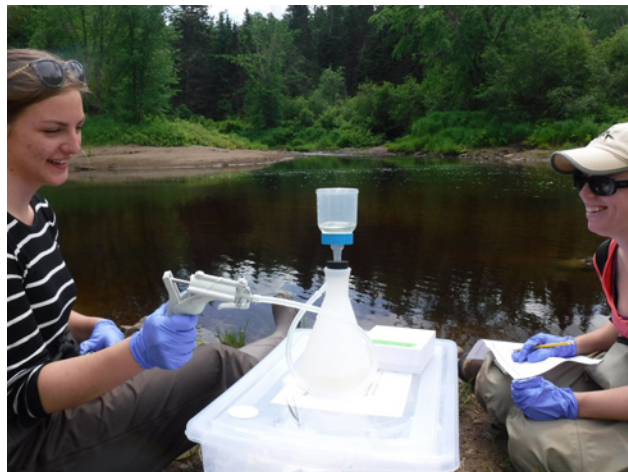
Photo : Prélèvement et filtration d'échantillons d'eau à des fins d'analyse (source : Southeastern Angles)
