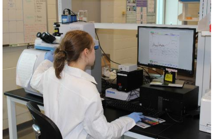
Lara Werbowski utilise un spectromètre Raman au Rochman Lab (Photo gracieusement fournie par Cole Brookson)
