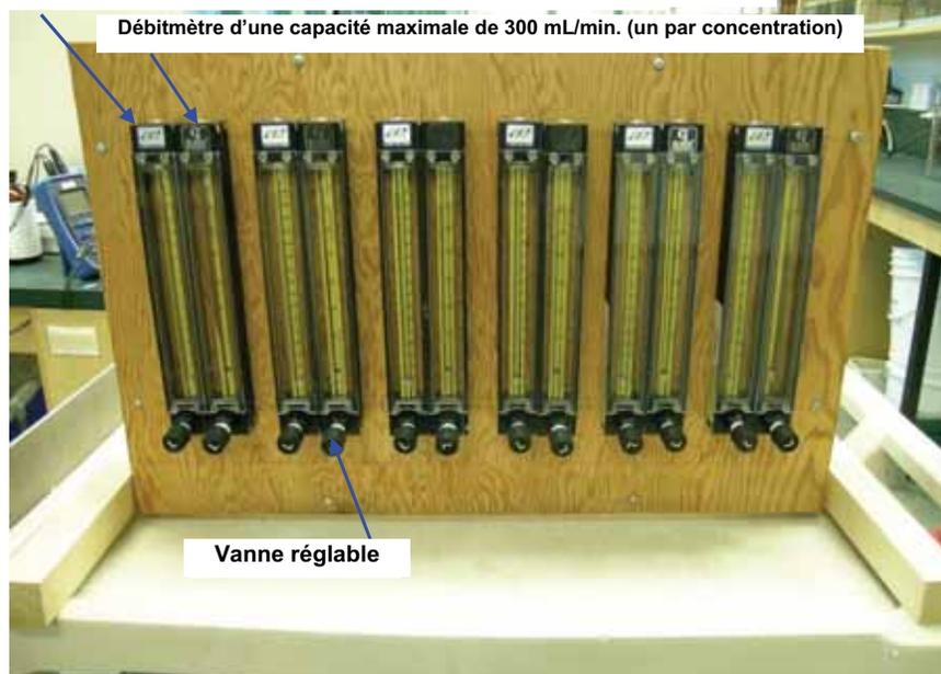
**Figure 2. — Vue de face du tableau de contrôle et des débitmètres pour l'application de la technique d'injection de CO<sub>2</sub>.**
