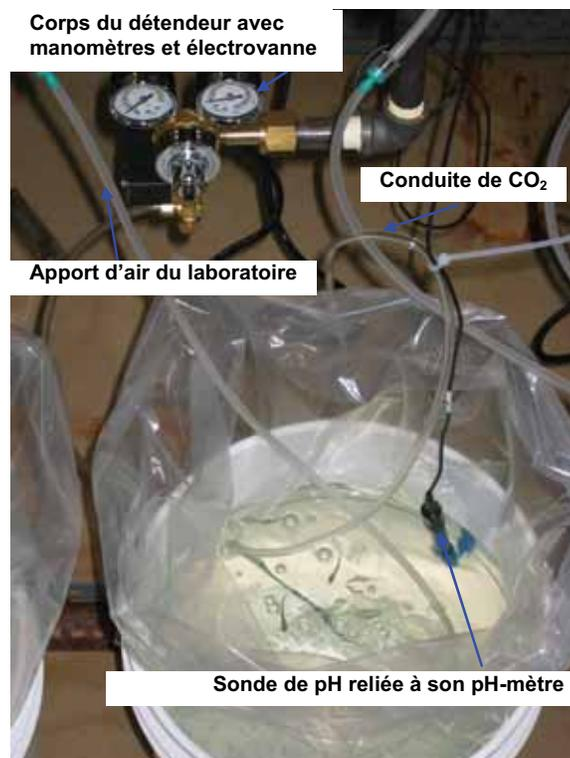
**Figure 10. — Montage expérimental pour la technique du pH-mètre régulateur**
