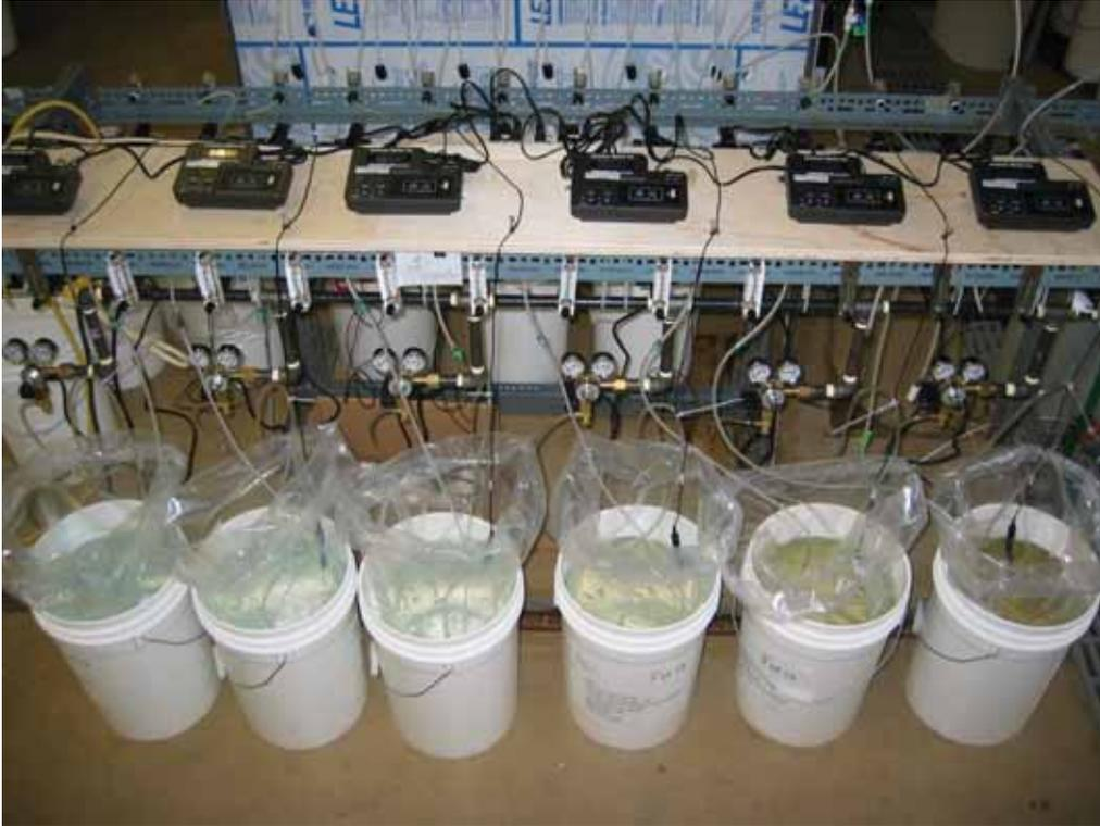
Figure 11. — Vue générale du montage employé pour l'essai de détermination de la CL50 utilisant la technique du pH-mètre régulateur
