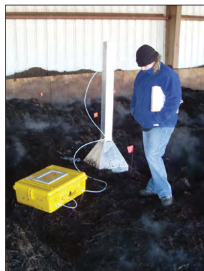
Photo 14-2 : Hotte d'échantillonnage utilisée pour recueillir des échantillons d'odeur à partir d'une pile de compost aérée © CH2M HILL
