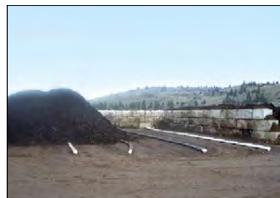
Photo 5-13 : Système typique de compostage en piles statiques aérées avec un aménagement de tuyaux hors sol; des murs de pierre séparent les lots afin de mieux utiliser l'espace disponible. © CH2M HILL
