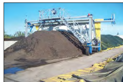
Photo 5-16 : Unité mobile utilisée pour placer et retirer les couvertures © CH2M HILL
