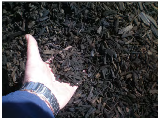
Photo 3-2 : Les grandes particules qui sont retirées du compost par le biais d'un tamisage peuvent être réutilisées si elles ne sont pas contaminées. © CH2M HILL
