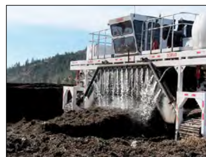
Photo 5-3 : De l'eau est ajoutée aux andains lorsqu'ils sont retournés. © CH2M HILL
