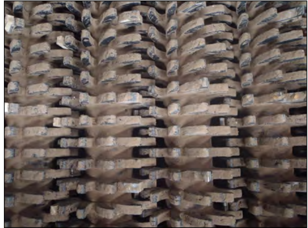
Photo 11-8 : Vue de dessus d'une série d'axes avec étoiles en caoutchouc dans un tamiseur étoile (l'écoulement de la matière se fait de gauche à droite à travers la plateforme) © CH2M HILL
