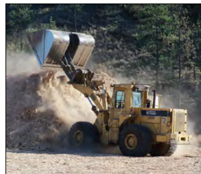
Photo 11-2 : Chargeuse frontale équipée d'un godet mobile, ce qui renforce considérablement la portée et la polyvalence © CH2M HILL
