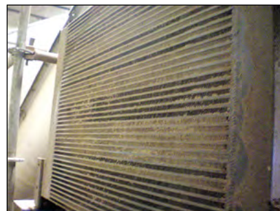
Photo 15-1 : La poussière peut rapidement bloquer les radiateurs des machines utilisées pour retourner les andains et d'autres machines, entraînant ainsi la surchauffe. © CH2M HILL
