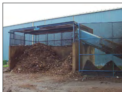
Photo 15-4 : Les enceintes autour de la sortie des convoyeurs des cribleurs permettent de confiner les déchets. © Scott Gamble
