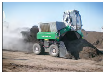
Photo 3-6 : L'équipement de retournement d'andain avec chargeuse frontale ou le vire-andain réintroduit l'oxygène et rétablit la porosité. © CH2M HILL
