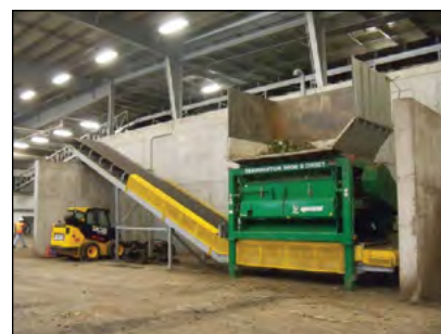
Photo 5-1 : Les déchiqueteuses par cisaillement sont couramment utilisées pour réduire la taille des particules et mélanger davantage les matières premières des matières organiques séparées à la source avant le compostage. © CH2M HILL
