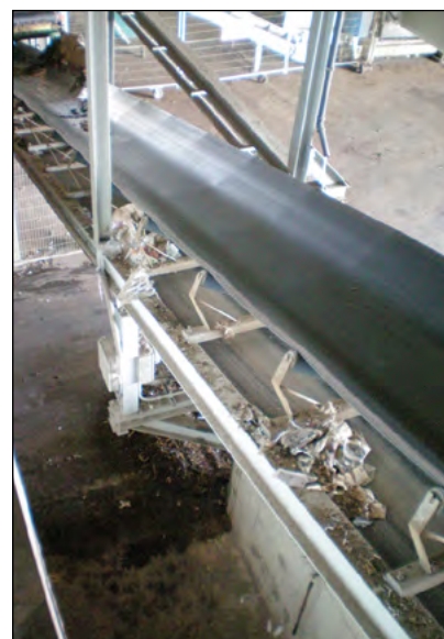
Photo 11-15 : Les convoyeurs permettent de déplacer efficacement de grandes quantités de matières au sein de l'installation de traitement. © CH2M HILL
