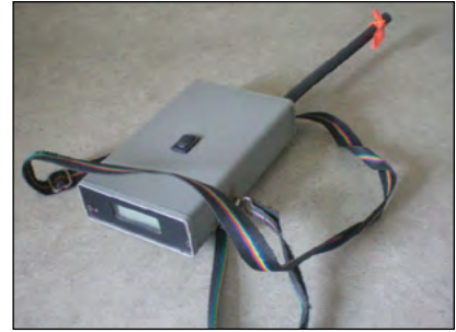
Photo 3-7 : Des instruments spécialisés sont utilisés pour mesurer les niveaux d'oxygène dans les piles de compostage. © CH2M HILL
