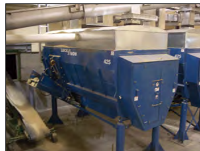
Photo 11-5 : Mélangeur horizontal à tarière © CH2M HILL
