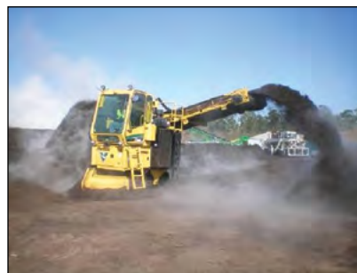
Photo 5-9 : Vire-andains autopropulsé utilisé pour le compostage en larges piles retournées © CH2M HILL
