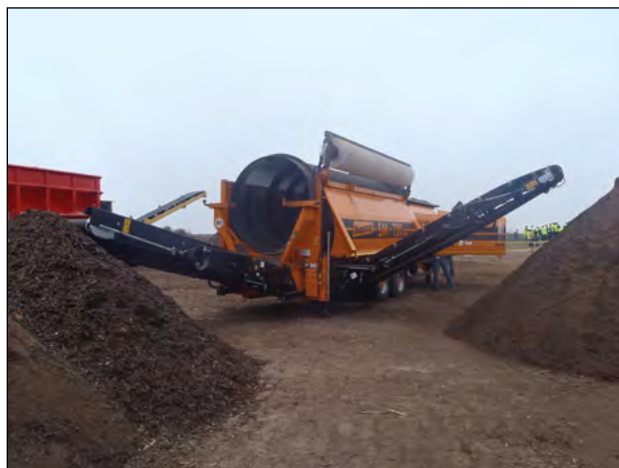
Photo 11-7 : Tamiseur à tambour rotatif : Les matières surdimensionnées tombent dans le tambour sur le convoyeur de gauche et les matières fines tombent à travers le grillage et sont déchargées du convoyeur par la droite. © CH2M HILL
