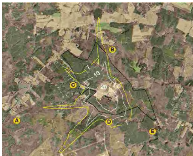
Figure 14-2 : Isoplètes du modèle d'odeurs pour des activités de compostage prévues © CH2M HILL
