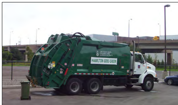
Photo 12-5 : Camion à deux compartiments pouvant être utilisé pour recueillir deux matières différentes © CH2M HILL
