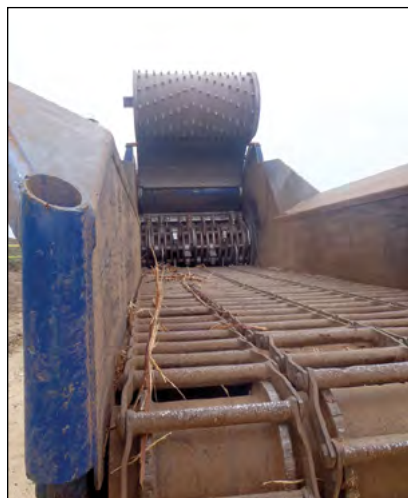
Photo 11-12 : Vue du convoyeur et de la chambre de broyage d'un broyeur horizontal © CH2M HILL
