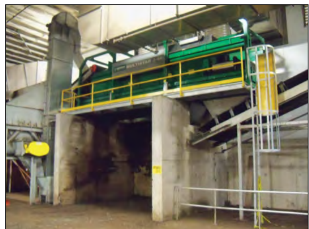
Photo 9-5 : Les concepteurs devraient fournir des échelles et des passerelles appropriées afin de pouvoir facilement accéder à l'équipement pour l'inspection et l'entretien. © CH2M HILL
