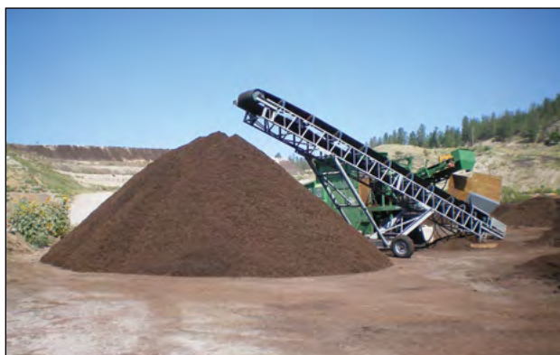
Photo 11-16 : Les convoyeurs empileurs permettent de créer de grandes piles entreposées avec une petite empreinte au sol. © CH2M HILL
