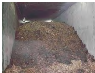
Photo 5-19 : Compostage en piles statiques aérées dans un tunnel en béton fermé © Scott Gamble
