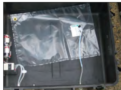
Photo 14-1 : Chambre à vide et sac Tedlar © CH2M HILL
