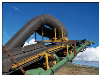
Photo 15-5 : Les systèmes d'aspiration peuvent être utilisés pour éliminer les déchets sauvages de la matière sur les convoyeurs. © CH2M HILL
