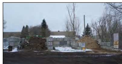
Photo 12-2 : Enceintes : blocs écologiques utilisés dans un dépôt de récupération de résidus verts © CH2M HILL
