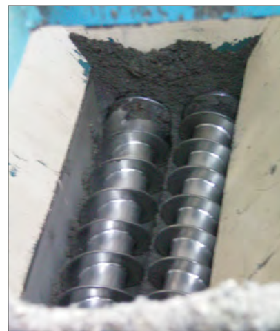
Photo 11-6 : Vue de dessus des tarières à l'intérieur d'un mélangeur horizontal © CH2M HILL
