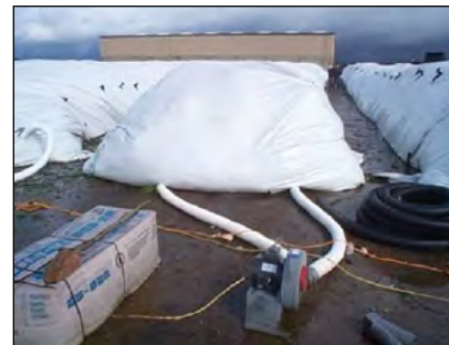
Photo 5-14 : Système de compostage utilisant des couvertures de polyéthylène © Scott Gamble
