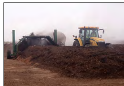
Photo 5-8 : Opération typique concernant le compostage en andains avec un vire-andains tracté © CH2M HILL
