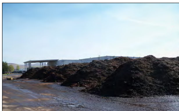
Photo 3-3 : Les andains sont couramment utilisés pour l'étape de maturation. © CH2M HILL
