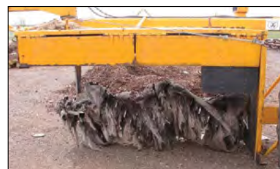
Photo 12-7 : Les sacs et les autres résidus en plastique peuvent s'emmêler dans les machines utilisées pour retourner les tas, et il est très difficile de les retirer. © Scott Gamble
