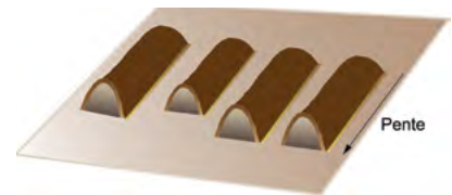
Figure 10-2 : Aménagement des andains dans une aire de maturation Les andains devraient toujours être orientés dans la même direction que la pente de l'aire de maturation afin de ne pas bloquer le drainage.
