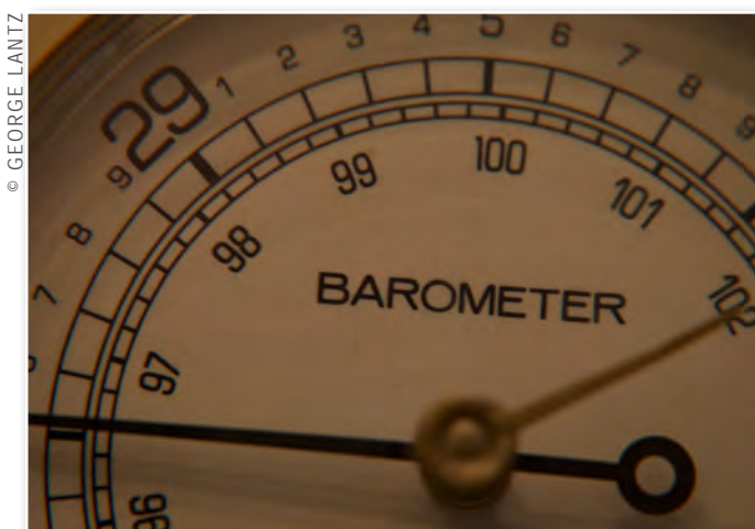
LA DIFFÉRENCE ENTRE LES AIGUILLES VOUS DIT SI LA PRESSION ATMOSPHÉRIQUE A AUGMENTÉ OU CHUTÉ DEPUIS VOTRE DERNIER AJUSTEMENT.
