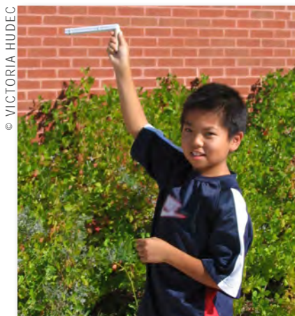
UN PSYCHROMÈTRE FRONDE SERT À DÉTERMINER LE POINT DE ROSÉE ET L'HUMIDITÉ RELATIVE.
