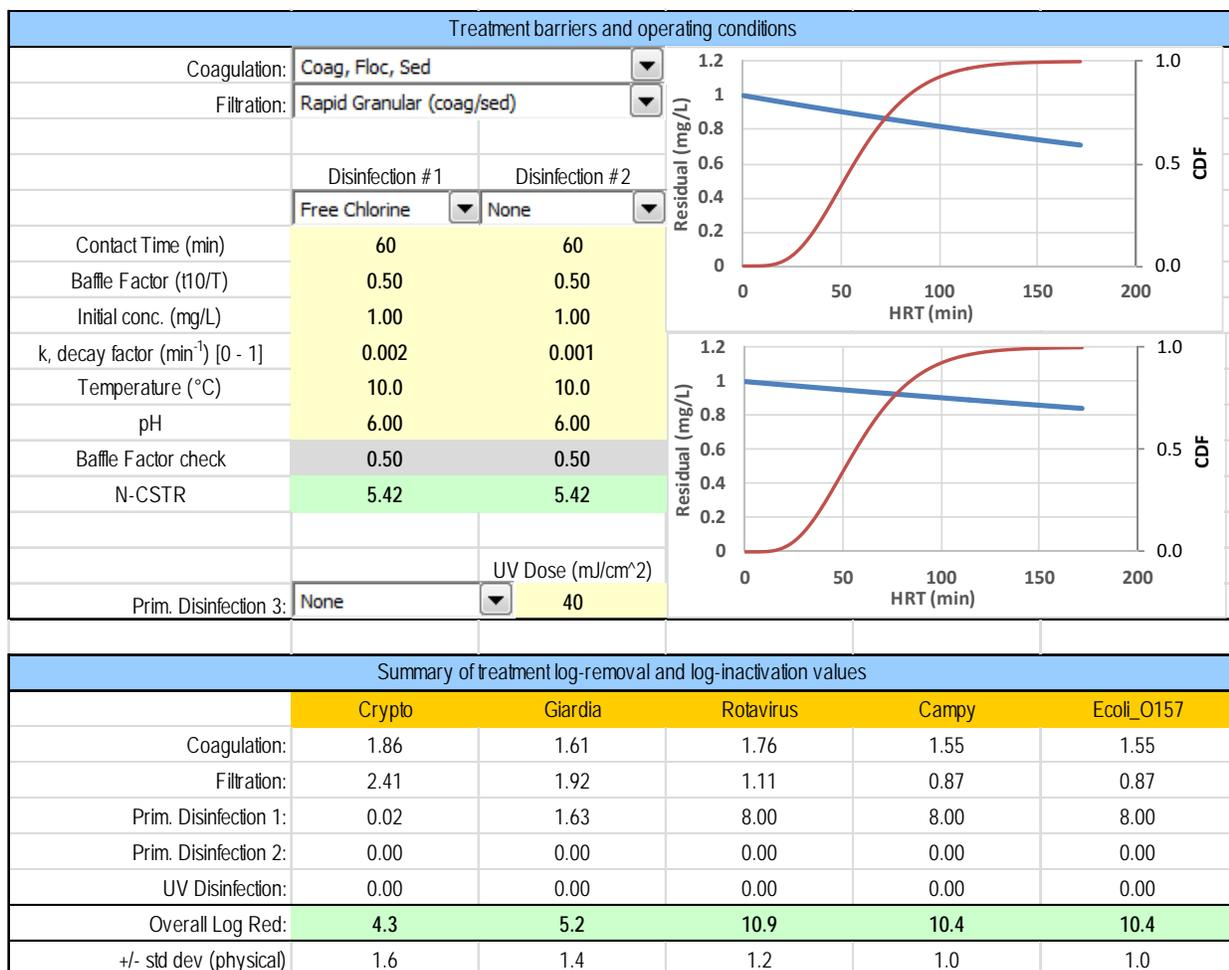
**Figure B2** : Les renseignements sur le procédé de traitement et le mode de fonctionnement sont saisis par l'utilisateur dans la feuille de calcul « Input\_Output ».
