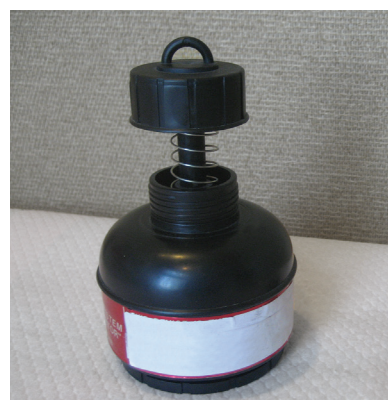
Figure 3 – Chambre d'ionisation avec électret – Mesure à long terme
