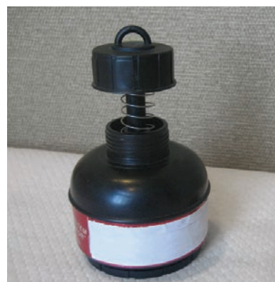
Figure 2 – Chambre d'ionisation avec électret à long terme
