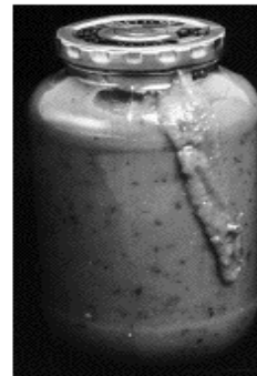
Bocal présentant des fuites, des fissures ou des éclats, ou produit décoloré
