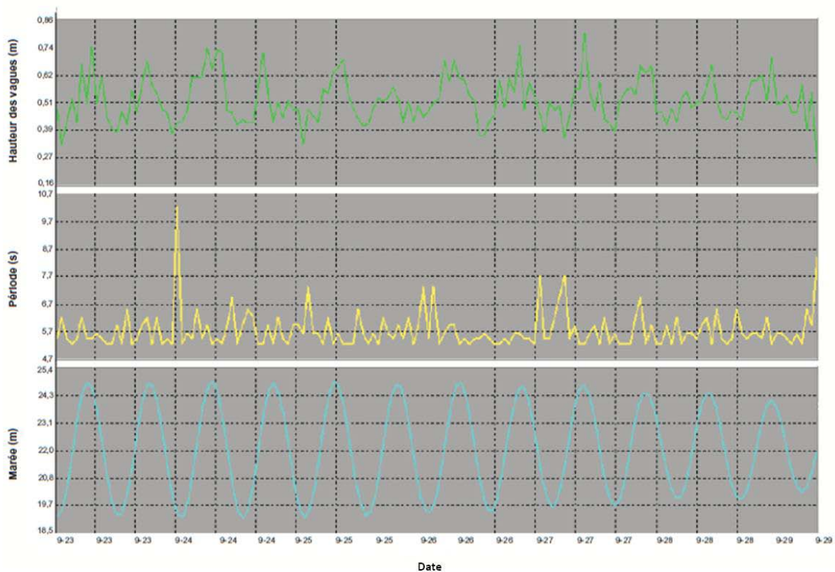
Figure 6.9 Séries d'enregistrement de la hauteur significative des vagues, de leur période et de la marée mesurée entre le 5 et le 22 septembre 2006 (modifiée de GENIVAR, 2007a).
