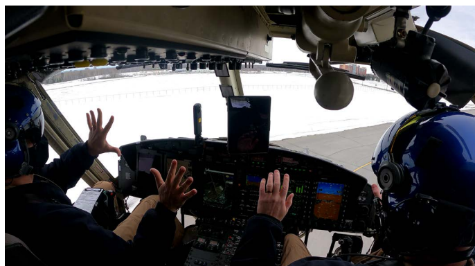
Vue du poste de pilotage de l'hélicoptère de recherche sur les systèmes évolués Bell 412 du CNRC avec des pilotes d'essai supervisant l'atterrissage autonome entre les obstacles
