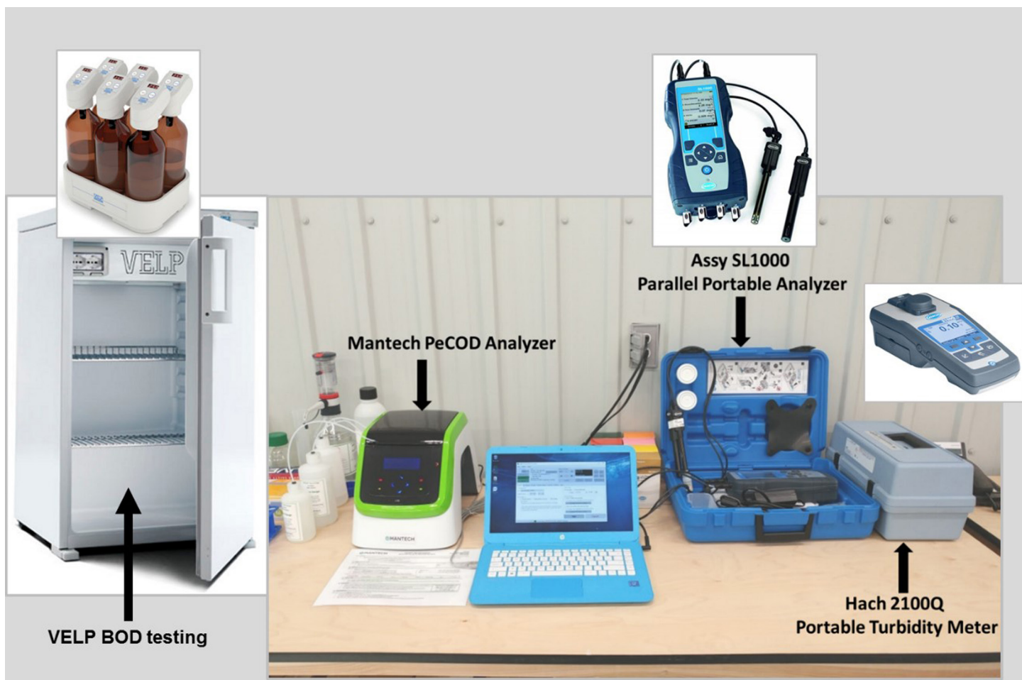
Figure 5 : Appareils d'analyse installés temporairement dans le bâtiment de recherche sur le terrain et d'entretien (BRE) de la SCREA.
