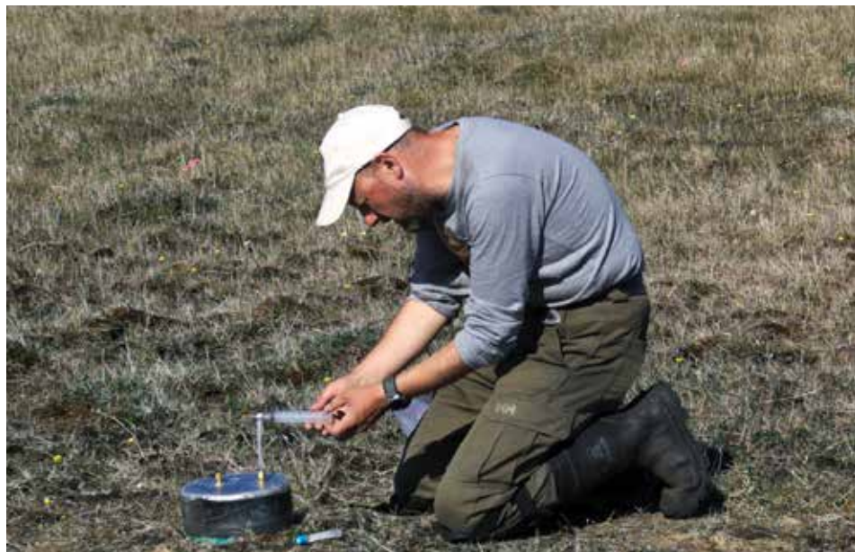
Johann Wagner, un scientifique de POLAIRE, mesure les flux de gaz à effet de serre dans la toundra mésique, à Cape Bounty, sur l'île Melville : Johann Wagner
