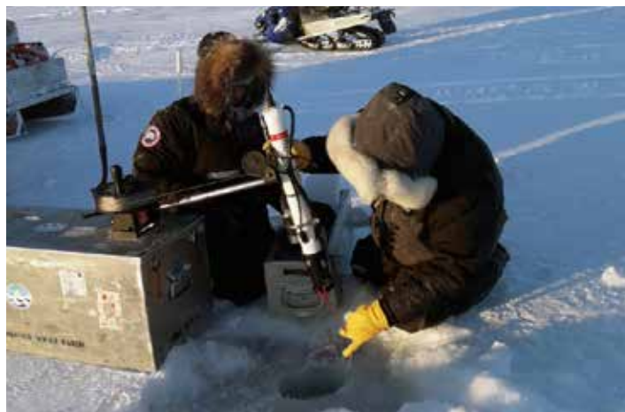
Tommy Epakohak (la gauche) et Ryan Angohiatok retirent de la glace un instrument de mesure de CTD, près des îles Finlayson, dans le cadre du programme CROW, en 2020 : Mike Dempsey
