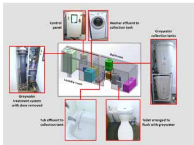
Un système de traitement des eaux grises semblable à celui installé à la SCREA : Terragon
