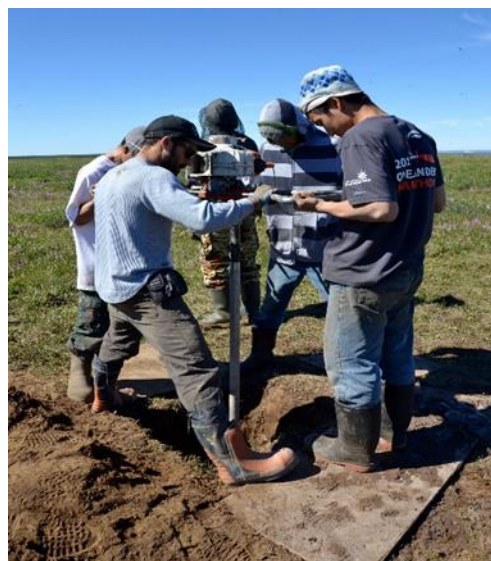
Des chercheurs et des membres de la communauté prélèvent un échantillon de pergélisol près de Kugluktuk, au Nunavut, pour une recherche sur la dégradation du pergélisol qui endommage un sentier routier tout-terrain local. Le sentier relie la collectivité.
