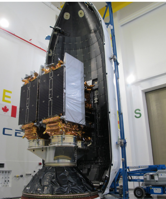
Mission de la constellation RADARSAT; installation des satellites dans le carénage de la fusée Space-X
