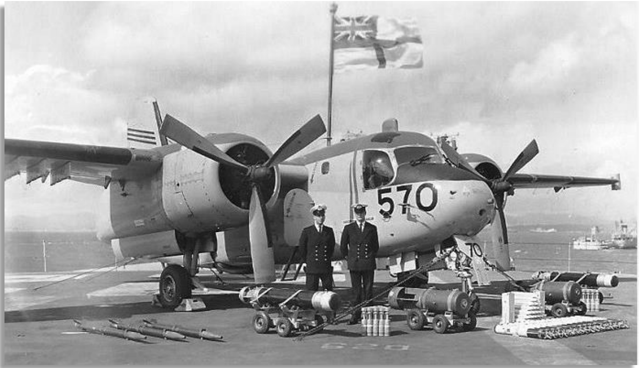
Les appareils De Havilland CS2F Tracker de l’Escadron de l’aéronavale VS-880 ont mené des missions de surveillance à partir de bases côtières et du NCSM Bonaventure. Cette photo illustre l’éventail de détecteurs et d’armes ASM qui était habituellement utilisé à bord des avions de patrouille maritime, y compris des bouées acoustiques, des roquettes air-surface, des bombes sous-marines et des torpilles ASM. (MDN)
