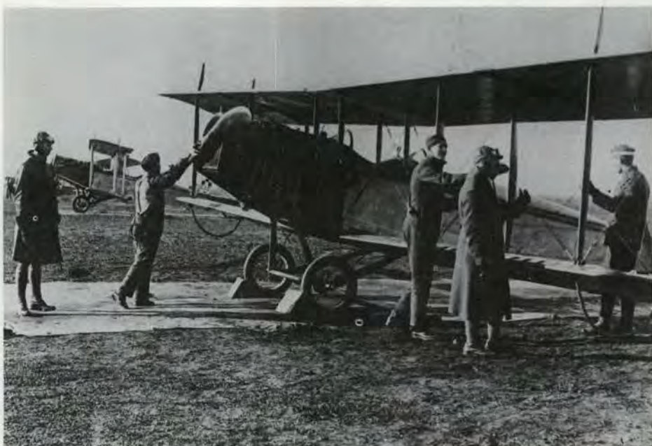
Avant l'envol, instructeur, cadet et mécanicien vérifient ensemble la solidité du croisillonage et des montants d'un JN4. (RE 19715)
