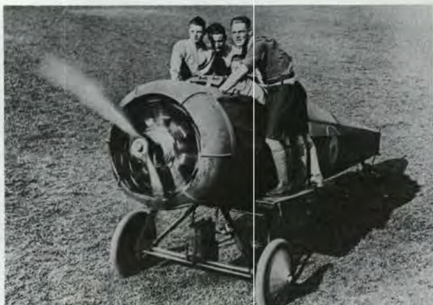
Avec des 'pingouins' (avions sans ailes et parfois sans queue), des élèves-pilotes apprennent à rouler un avion sur un aérodrome. (AH 518)
