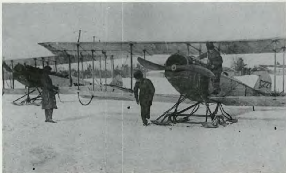
Avions JN4 équipés de skis spéciaux conçus par le Canadian Aeroplanes Ltd , probablement en février 1918. (RE 19071-16)
