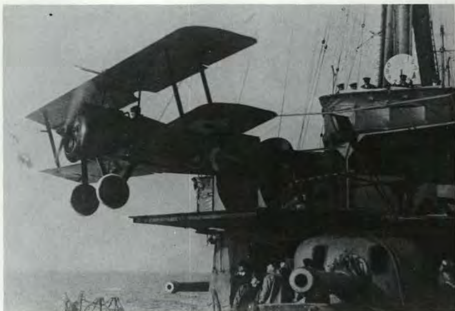
En 1918, un Sopwith Camel piloté par le sous-lieutenant W.S. Lockhart de Moncton (N.-B.) décolle de la rampe de la tourelle-avant du croiseur léger Sydney . Les appareils devaient aller atterrir sur la côte ou se poser en mer à proximité du navire. (PMR 71872)
