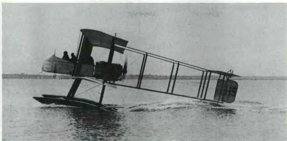
Un avion Maurice Farman 'Shorthorn' transformé en hydravion et piloté par le sous-lieutenant de section H.A. Peck, de Montréal, décollant de la base de Felixstowe, probablement en 1915. (RE 19409-3)
