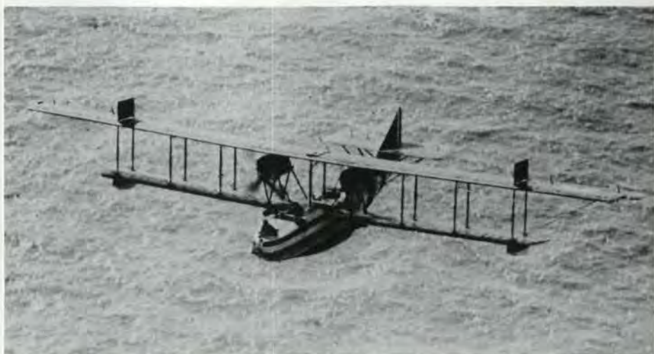
Un hydravion F2a, en camouflage bariolé, photographié au cours d'une patrouille. Cet appareil avait la coque d'un hydravion Porte et les ailes et la queue d'un Curtiss H12 'Large America.' Grâce à sa coque en V arrondie, le F2a pouvait bien mieux que le H12 se poser et décoller en mer par gros temps. (AH 572)
