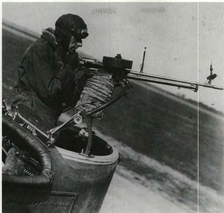
Le nez d'un bombardier Handley Page. On voit sur la mitrailleuse Lewis le chargeur circulaire et sous elle, à droite du mitrailleur, le sac destinée à recueillir les douilles vides pour éviter que le vent ne les jette au visage du pilote. (AH 530)
