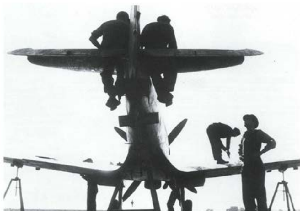
Les mitrailleuses d'un Spitfire sont ajustées tandis que des crics maintiennent les ailes et le fuselage arrière au niveau et qu'un fil de plomb pend du nez de l'avion. (PL 18516)
