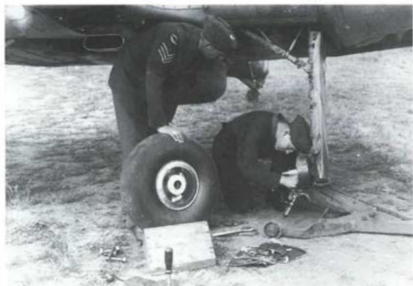
L'entretien du train d'atterrissage d'un Hurricane II du 401 e Escadron à l'été de 1941. (PL 4471)
