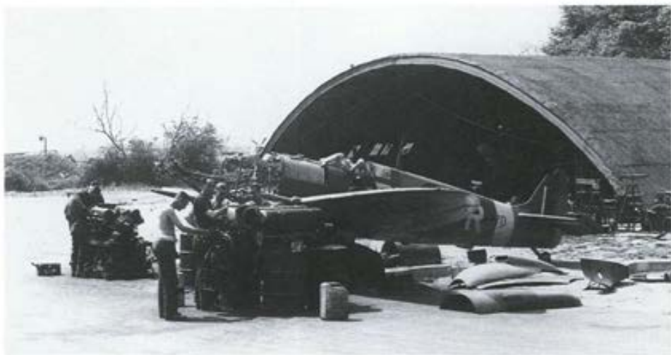
Un Spitfire IX change de moteur peu de temps avant l'invasion de la Normandie. (PL 29564)
