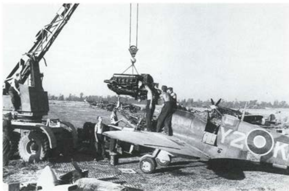
Changement de moteur sur un Spitfire du 442e Escadron en août 1944. (PL 31363)
