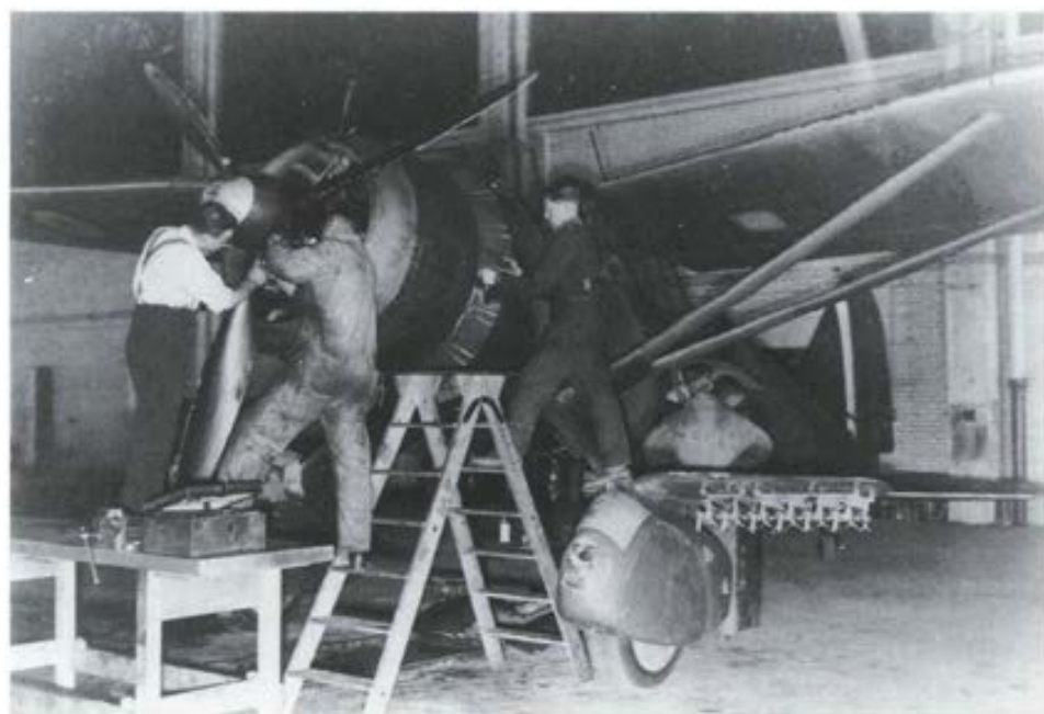
Des ajusteurs travaillent sur le moteur d'un Lysander du 110 e Escadron de l'ARC (plus tard le 400 e ) dans un hangar à Odiham à l'automne 1940. Les objets sur l'aile courte, en saillie du train d'atterrissage, sont des lance-bombes pour bombes légères. (PMR 93-296)
