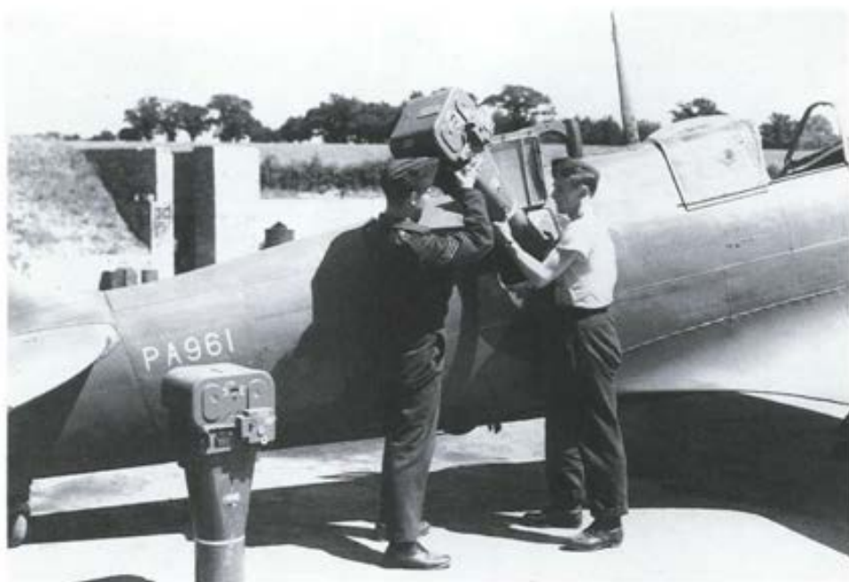
Le personnel non navigant charge une caméra oblique sur un Spitfire XI du 400 e Escadron à l'automne de 1944. (PL 40301)
