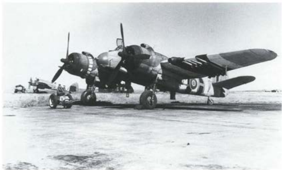
Un Bristol Beaufighter Mark X du 404 e Escadron avec ses indicatifs d'invasion fraîchement peints en juin 1944. L'arme principale contre le trafic maritime utilisée par les Canadiens était la roquette de trois pouces dont l'ogive de 25 livres pouvait percer les blindages. Elle était lancée des rails situés sous les ailes. (PL 41049)
