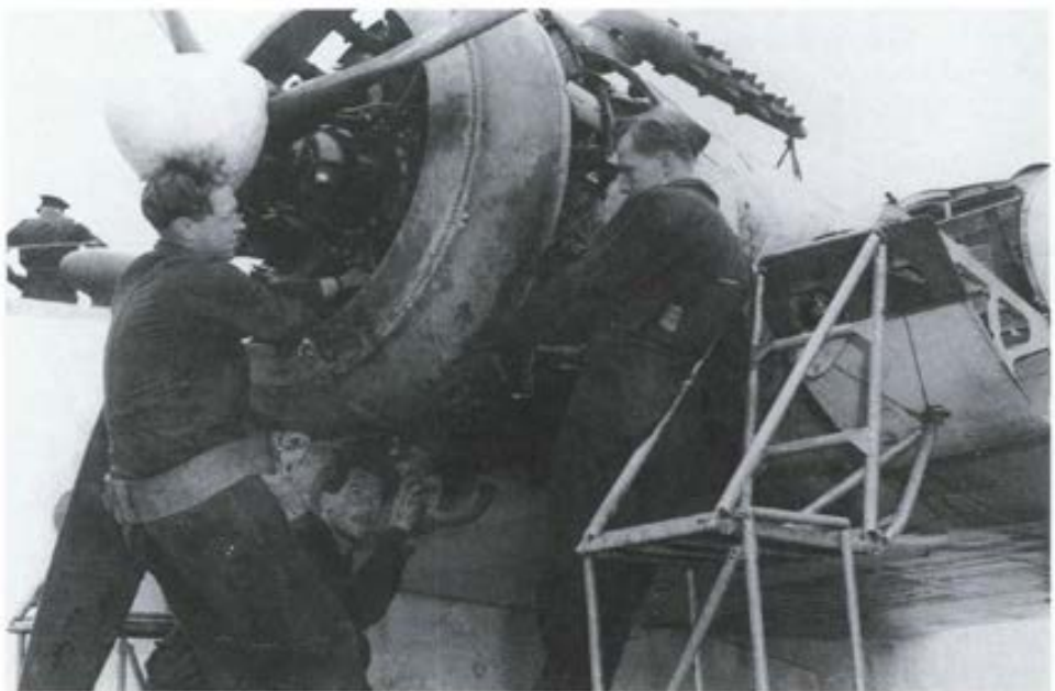
Travaillant sur une plate-forme flottante, des mécaniciens examinent un des quatre moteurs Bristol Pegasus d'un hydravion Sunderland de l'ARC. (PL 31437)
