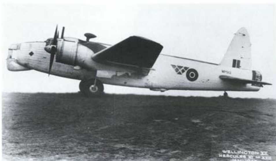
Un Vickers Wellington Mark XII équipé d'un projecteur Leigh, similaire à ceux utilisés par le 407 e Escadron. Le projecteur rétractable Leigh est visible sous le fuselage, juste derrière l'aile, tandis que le radar ASV III est situé dans le dôme sous le nez de l'appareil. (RE 19876-11)
