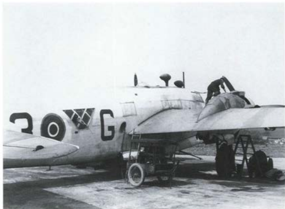
La révision d'un Wellington Leigh Light. Par la position du mitrailleur latéral, on voit clairement la structure en treillis qui en fait une machine solide, capable de supporter des coups sévères. (PL 40927)
