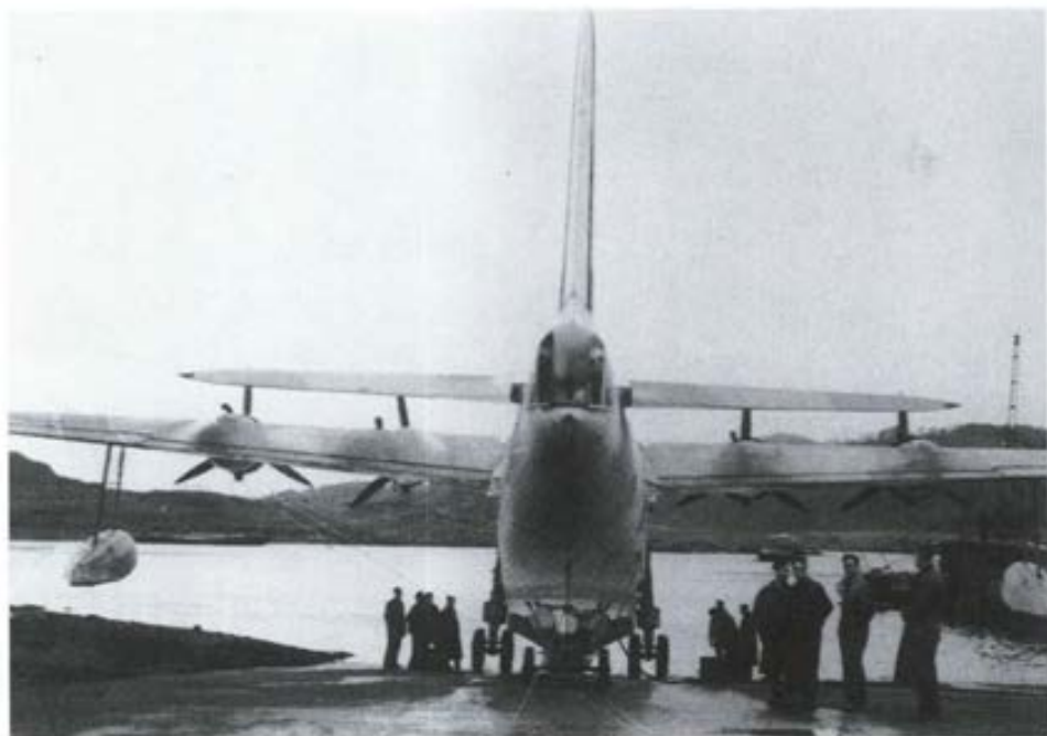
Un Sunderland est retiré pour en faire l'entretien. Traîner ces avions de 26 tonnes sur la berge pouvait s'avérer une opération délicate. (PL 15751)
