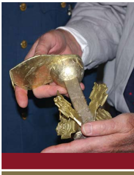
Le jeu de matrices, une fois démoulé, avec quatre insignes de la Croix de Victoria encore rattachés à la tige centrale.
