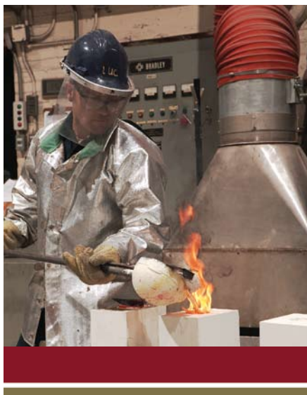
Seconde étape du coulage, lorsque l'alliage est versé dans les moules pour créer les insignes de la Croix de Victoria.
