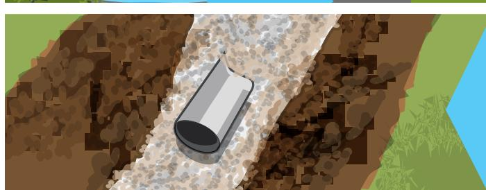
Installer des drains en pierres sèches (ou drains agricoles) aux endroits gorgés d'eau.
